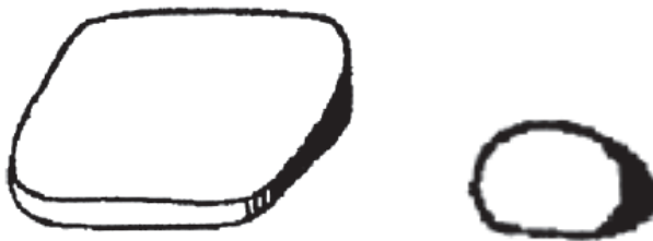
2.5 pav. Plokščios (kairėje) ir sferiškos (dešinėje) dalelės forma (Prušinskienė 2012)
