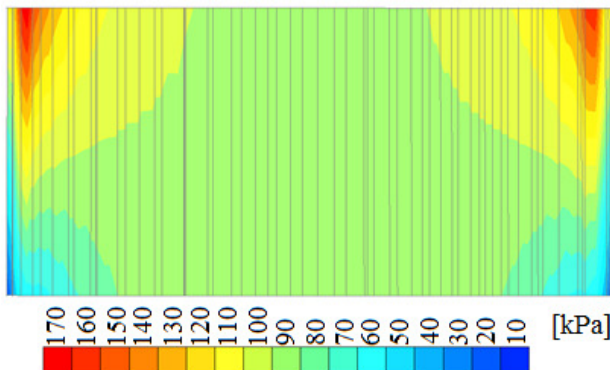
2.52 pav. Tangentinių įtempių pasiskirstymas odometre
