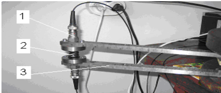
2.2 pav. Virpesių perdavimo spyruokle savybių tyrimo standas:
