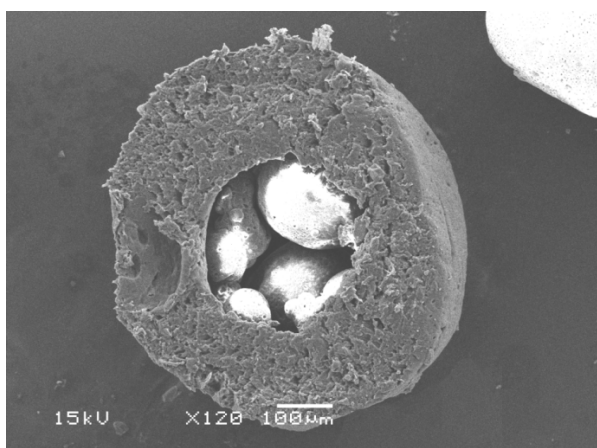
Gambar 3. Foto Scanning Electron Microscope (SEM) mikrokapsul formula 4 pada pembesaran 120 kali
