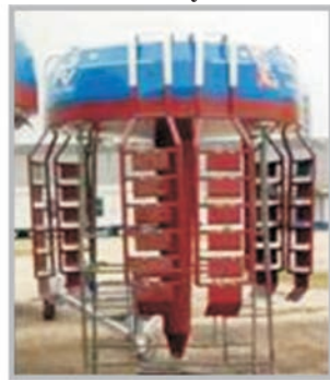
A. Disposición y sujeción de los cupones a los racks.
