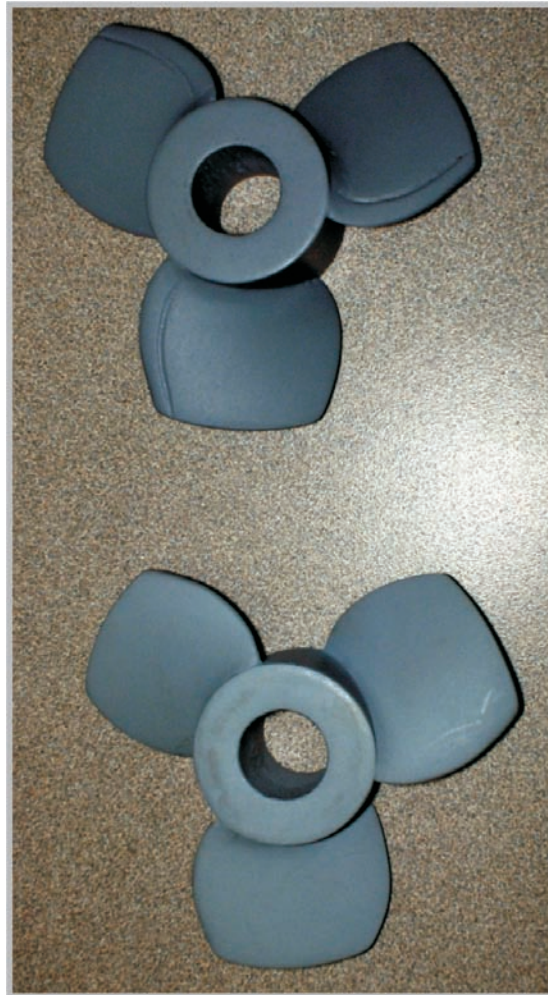
C. Hélices con y sin ranura. Construidas mediante prototipado rápido con tecnología FDM ( Fused Deposition Modeling ) y recubiertas con una masilla plástica de poliéster.
