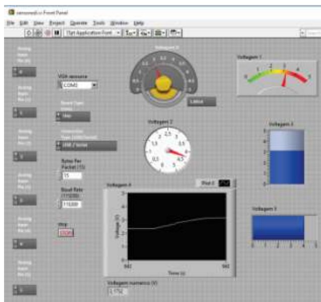
Figura 3. Painel frontal do aplicativo em LV para comando do sistema de aquisição de dados. Este software permite a seleção do tipo de comunicação entre a placa e o computador, o modelo de placa Arduino, as portas analógicas que serão usadas, o início e fim do processo além de mostrar em escalas gráficas diversas os valores de tensão elétrica digitais coletados em cada porta.
