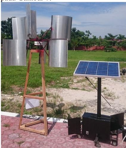
Gambar 7. Hasil pembangkit listrik hybrid angin dan surya
