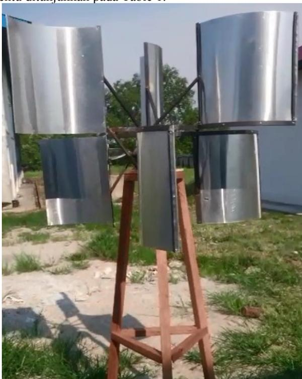
Gambar 4. Hasil perancangan *Vertical Wind Axis Turbin* (VWAT)
