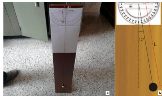
Figura 4. a) Diseño experimental; b) Péndulo simple estudiado.
