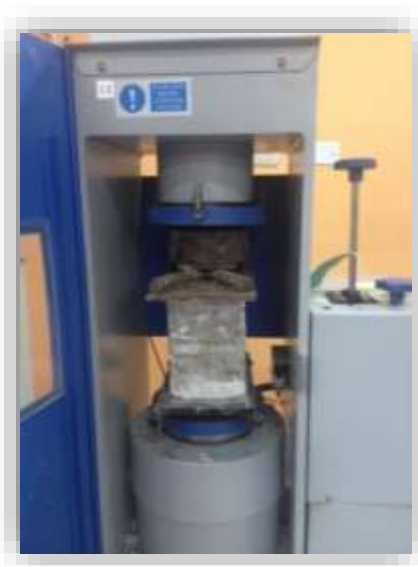
Figura 10. Pilas de albañilería sujeta compresión axial
