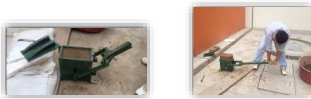
Figura 4. Proceso de elaboración de la unidad de albañilería suelo-cemento.
