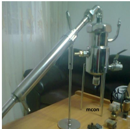
Fig.A-2 Recipiente de flasheado para condensado de alta presión
