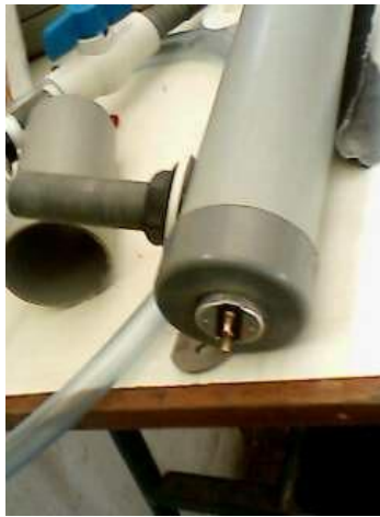
Figura 2. Vista del extremo del equipo de irradiación UV
