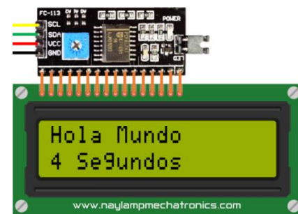
(e). Conexión del display LCD 1602 con modulo adaptador LCD a I2C
