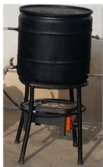
Figura 9. Tanque acumulador-intercambiador de calor (TAIC).
