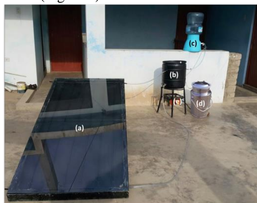
Figura 7. Fotografía del equipo pasteurizador: (a) colector solar CS, (b) tanque acumulador-intercambiador de calor TAIC, (c) tanque alimentador de leche sin pasteurizar TALSP, (d) tanque receptor de leche pasteurizada TRLP, (e) sistema auxiliar (hornilla de gas propano).
