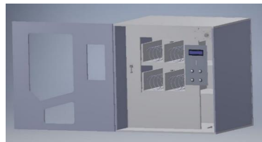
Gambar 2. Desain mekanik Vending Machine dengan aplikasi Inventor
