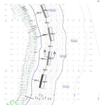
Gambar 17. Layout Penempatan Struktur Breakwater
