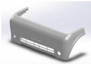
Gambar 3. Bumper depan rancangan baru
