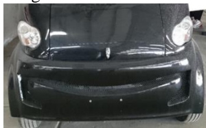
Gambar 1. Bumper depan mobil GEA yang lama
