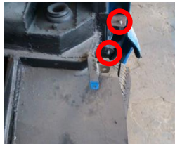
Gambar 12. Peletakan lubang untuk sambungan baut
