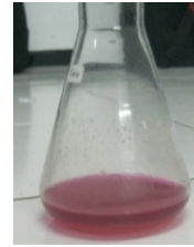
Gambar. 1. Pengukuran FFA dengan titrasi.
