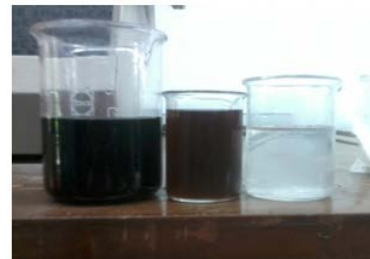
Gambar. 3. Hasil uji coba arang aktif pada air keruh.
