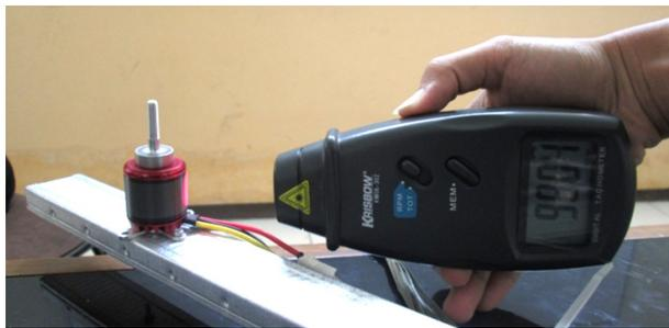
Gambar 8 Pengukuran kecepatan putaran motor dengan *tachometer*
