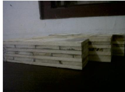
Gambar 3.3. Specimen Uji Tekan Variasi 1
