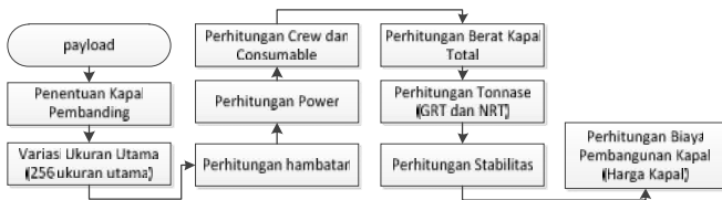
Gambar 5. Tahapan proses Penentuan ukuran utama supply vessel berdasarkan dari Pedoman pengerjaan Tugas Merancang I 2004, Petrus Eko Panunggal [3]
