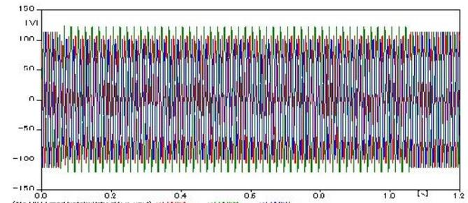
Gambar 8. Gelombang Voltage Sag di Fault 2 Durasi 1 s Hubung Singkat Antar Fasa
