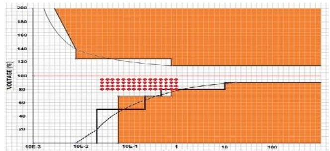
Gambar 14. Plot Kurva Hubung Singkat 1 Fasa ke Tanah di *Fault 2* dan *Fault 3* dengan Metode 1 Durasi 200 ms, 600 ms, dan 1 s pada Kaltim 1A dan Kaltim 3
