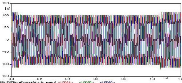
Gambar 6. Gelombang Voltage Sag di Fault 2 Durasi 1 s Hubung Singkat 3 Fasa
