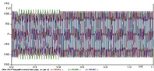
Gambar 11. Gelombang *Voltage Sag* di *Fault 2* Durasi 600 ms dan 1 s Hubung Singkat Antar Fasa
