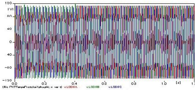
Gambar 10. Gelombang *Voltage Sag* di *Fault 2* Durasi 600 ms dan 1 s Hubung Singkat 1 Fasa ke Tanah
