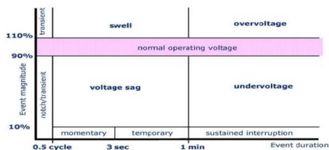
Gambar 1. Definisi Peristiwa Tegangan Berdasarkan IEEE 1159-1995[1]
