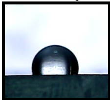
Gambar 1. Tampak depan tetesan cairan (akua demineralisasi) pada permukaan lapisan padatan politetrafluoroetilen.
