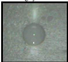
Gambar 2. Tampak atas tetesan cairan (akua demineralisasi) pada permukaan lapisan padatan politetrafluoroetilen.
