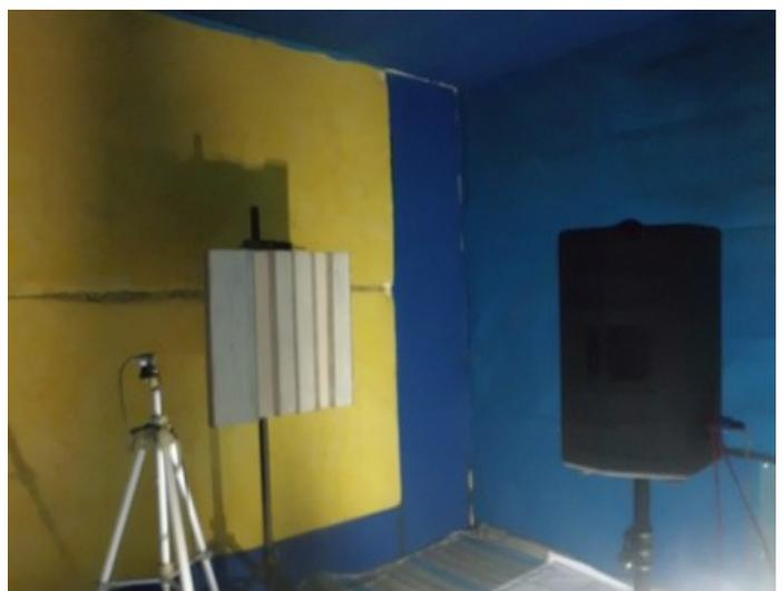
**Gambar 4.** Gambar Difuser dengan Pola Sumur 0142241 dengan jumlah sumur 7 buah lebar sumur 0,085m.
