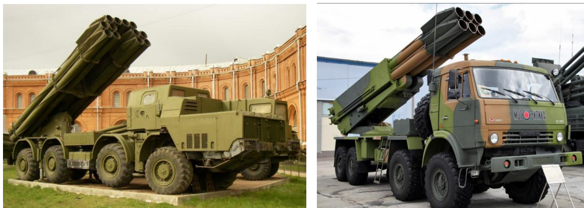
Рис. 1. 300-мм РСЗО «Смерч» на двух вариантах носителей разной массы. Слева – боевая машина 9А52-2 массой 43,7 т, справа – боевая машина 9А52-4 массой 24,7 т
