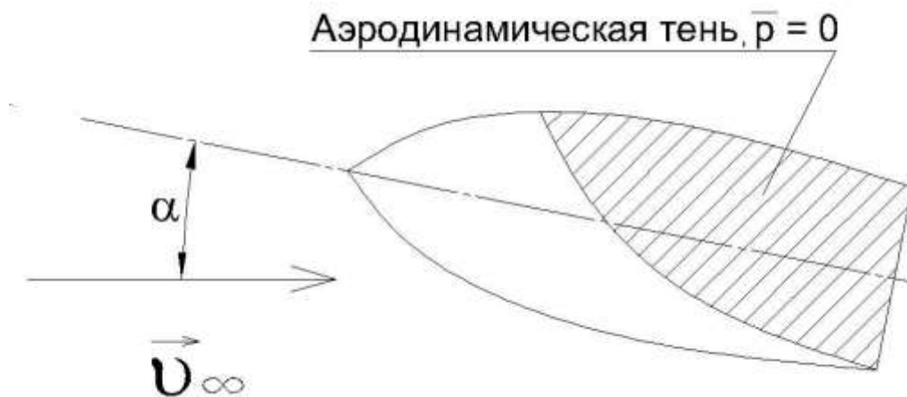
Рис. 1. Приближённая схема обтекания тела гиперзвуковым потоком.
