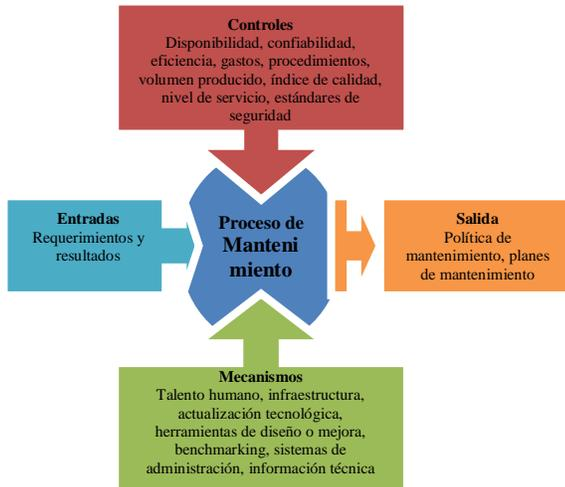
Fig. 1. Diagrama de proceso para la función mantenimiento [11]
