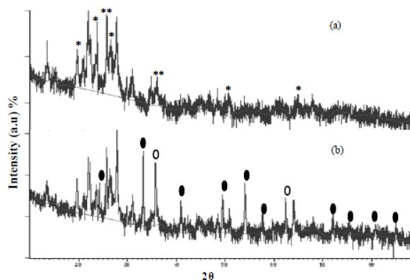
**Gambar 3.** Hasil analisa XRD (a) zeolit setelah aktivasi dan (b) zeolit-Fe<sub>2</sub>O<sub>3</sub>
