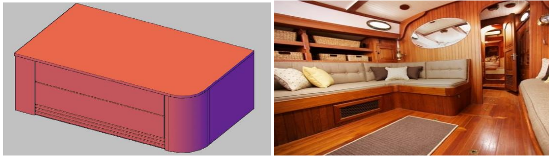
Şekil 12. CNC'de üretilemeyen bombeli parçaya sahip yat mobilyası [3, 16].
