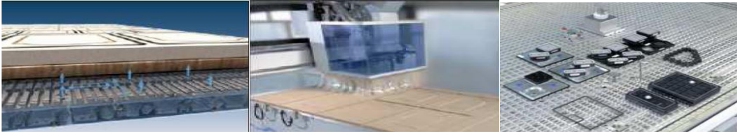
Şekil 8. CNC makinesi tabla vakum üniteleri ve parça işlenmesi [3].
