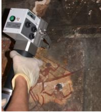
Şekil 16. Lazer ile yüzey temizliği(a)[20]
