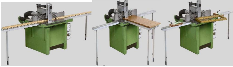
Şekil 7. Yatay freze makinesi güvenli çalışma masası ve sper ile parça işlenmesi [27].
