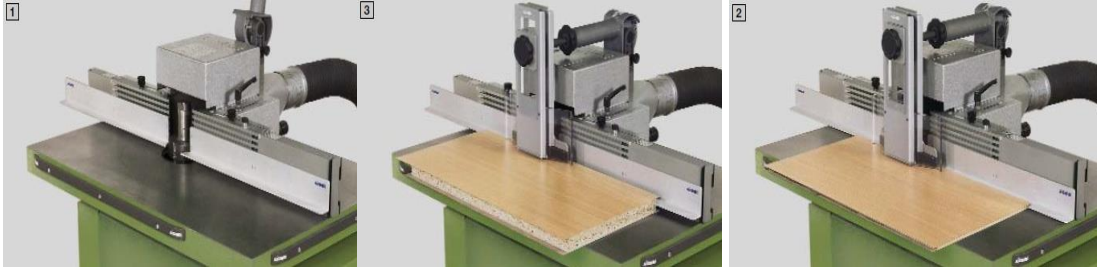
Şekil 15. Freze’de kavisli parça işlemede ek tabla, sper ve robot kullanımı[27].
