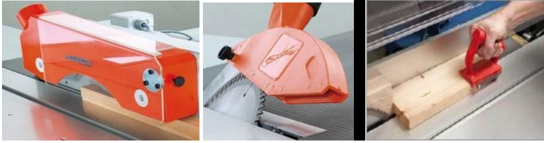
Şekil 21. Yatay Daire Testere makinesi kalıp-sper ve güvenlik donanımı[26].
