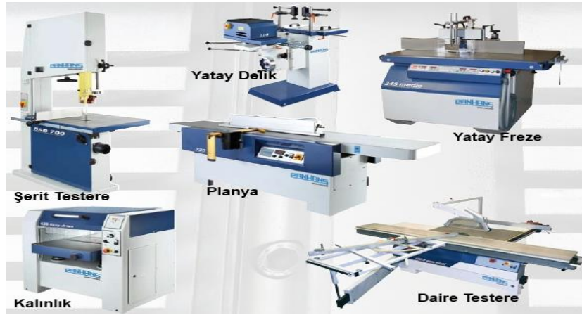
Şekil 2. Ağaç işleri ve mobilya sanayide kullanılan konvansiyonel makineler [26].
