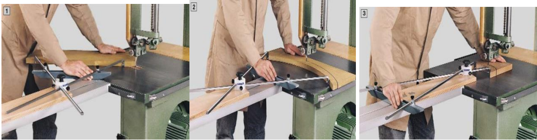
Şekil 23. Şerit Testere’de çalışma masası ve kavisli kesim için kalıp donanımı[27].
