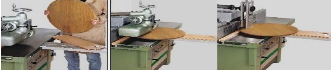
Şekil 13. Freze'de kavisli parça işlemede ek tabla, sper ve robot kullanımı[27].
