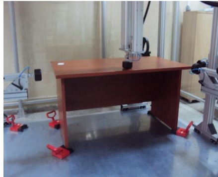
Şekil 8. TS EN 527-3 Büro Masaları Düşey Denge [39].
