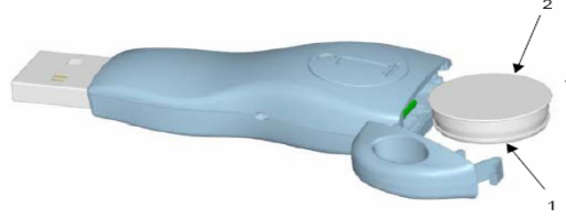
Şekil 1.6. DS9490Bye iButtonun yerleştirilmesi
