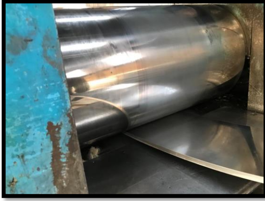
Şekil 4. Haddede kalınlığı azaltılan alüminyum
