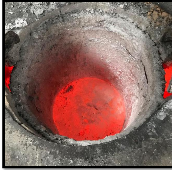
Şekil 1. Döküm esnasında ergitilen alüminyum
