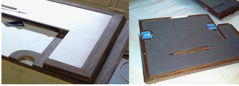
Şekil 4. Esnek PVC (beyaz) üzeri deri uygulaması
