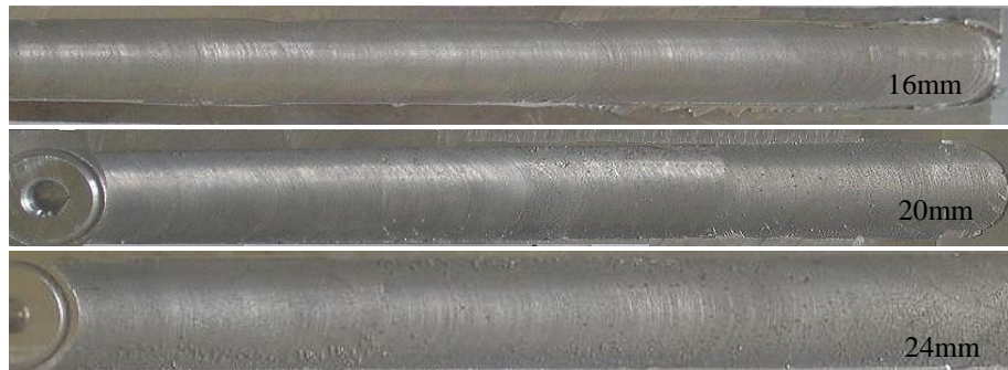
Şekil 5. Kaynaklı birleştirmelere ait yüzey resimleri
