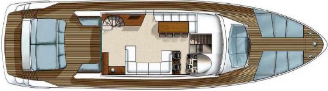
Şekil 4. HT 78 Main deck yerleşim planı ve mobilyalar [12].
