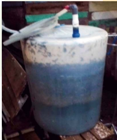
Gambar 1. Digester tempat fermentasi enceng gondok
