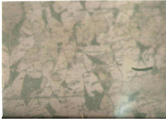
Gambar 19: Daerah HAZ Spesimen dengan arus 100 A dan kecepatan 0,25 cm/dtk
