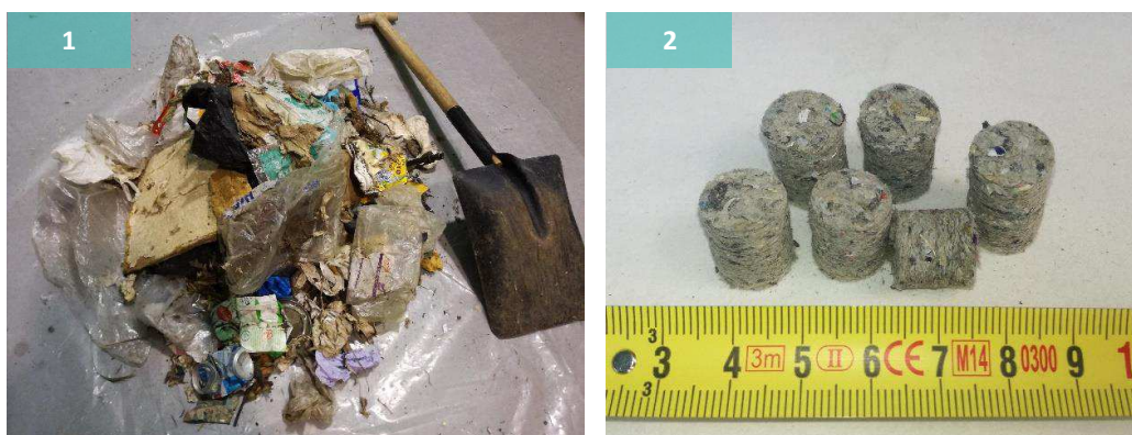
Figura 7.1 Muestra tomada en una planta de TMB (1); pellets de 1 gramo para el análisis del PCI
