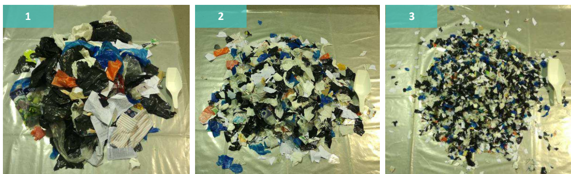
Figura 7.13 Tamaños de partícula antes de la división por cuarteo: MA2 (1), MA3 (2) y MA4 (3)
