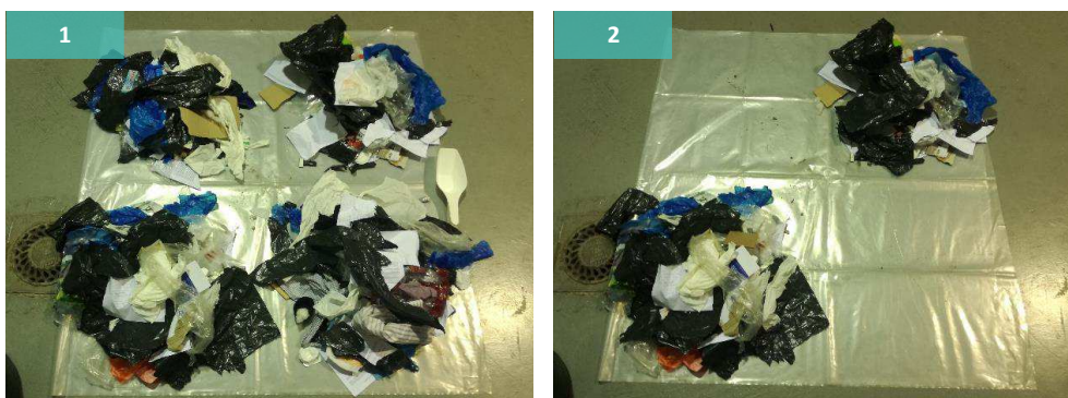
Figura 7.14 CNL2: Primer cuarteo (1) y muestra obtenida (2)
