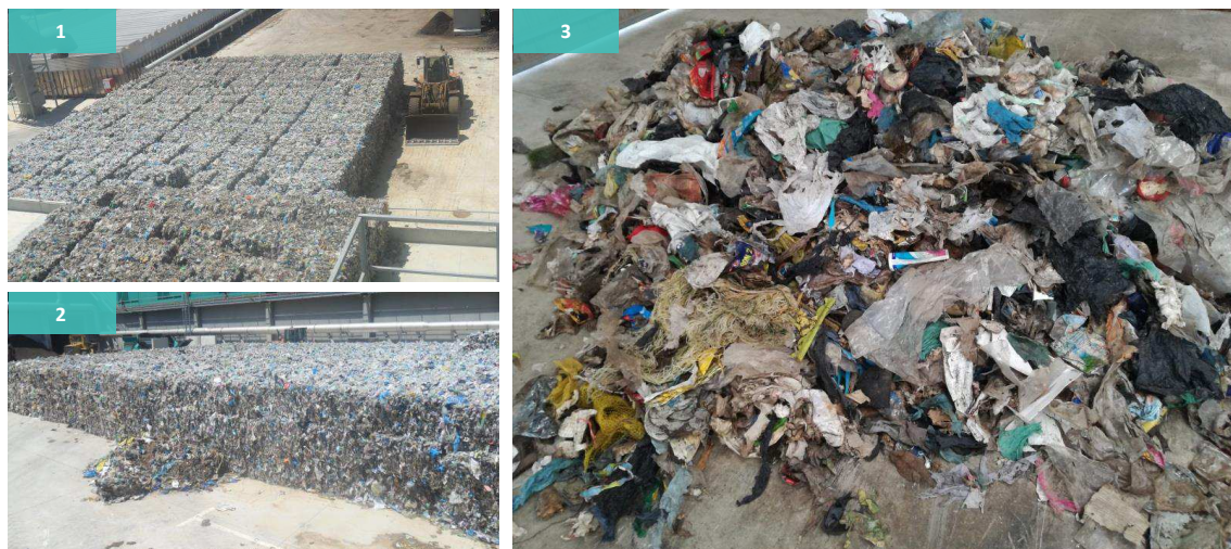
Figura 2.19 Balas de rechazo para su depósito en vertedero (1 y 2) y rechazo del TMB (3)
