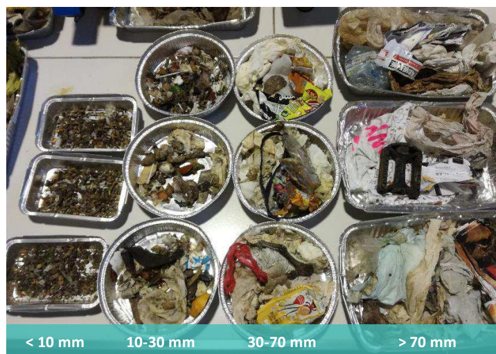
Figura 7.37 Bandejas de RRAP-G para la monitorización del proceso de secado
