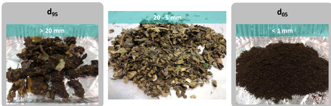
Figura 6.8 Tamaño nominal superior, tamaño mínimo de partícula y tamaño de partícula predominante en el RAB2-O
