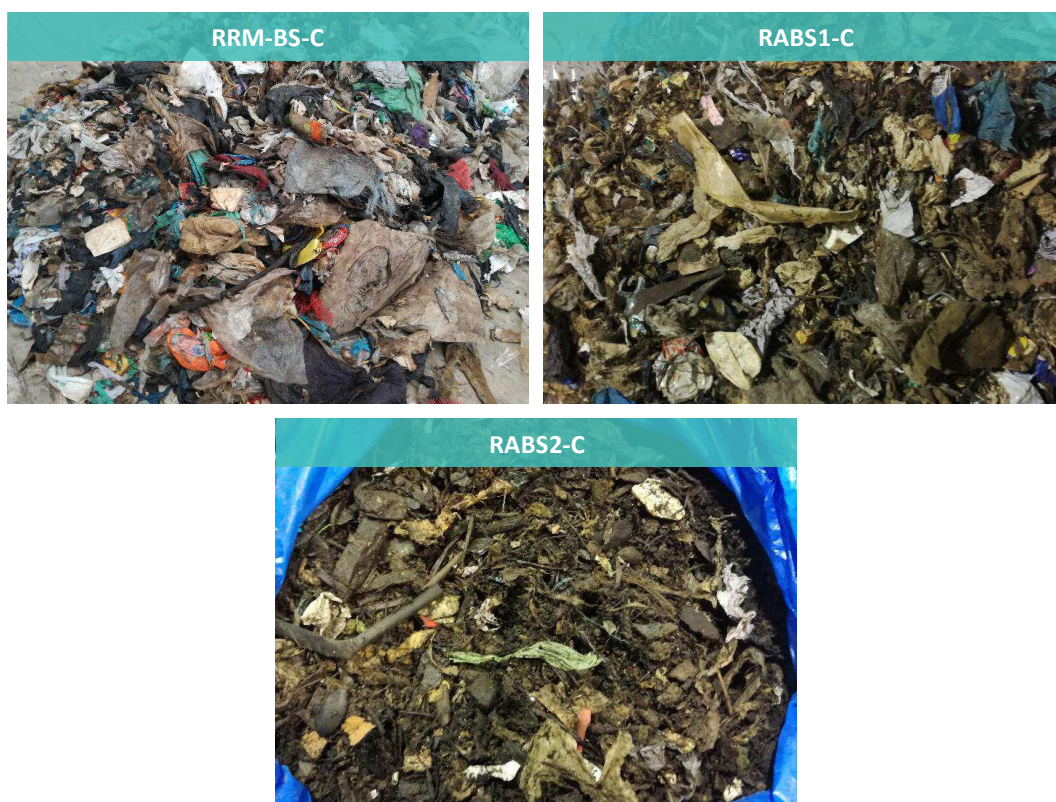
Figura 6.23 Rechazos generados en la planta de biosecado y recuperación de Cervera
