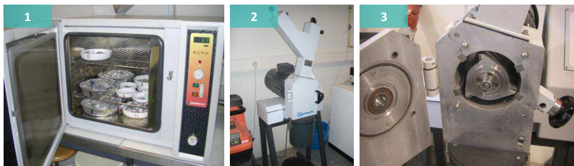
Figura 7.5 Estufa CARBOLITE para el secado (1) y molino de corte RETSCH modelo SM-2000 (2 y 3)
