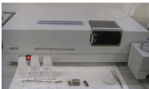
Figura 7.9 Analizador de mercurio LECO AMA-254
