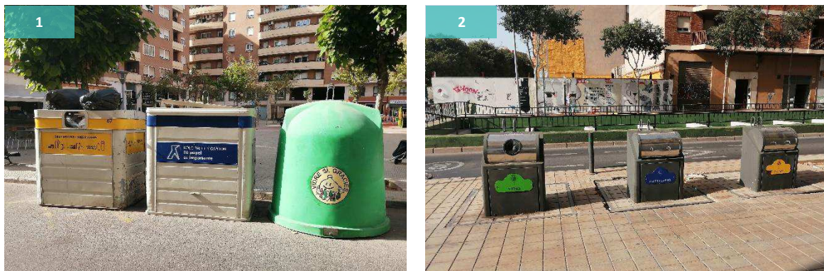
Figura 2.9 Recogida de RSU en áreas de aportación: contenedores en superficie (1) y soterrados (2)
