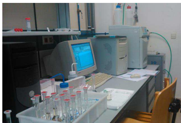
Figura 7.8 Soluciones preparadas para su análisis y cromatógrafo iónico DIONEX DX-120
