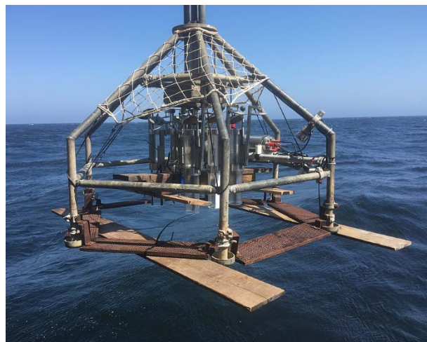
Abb.2: Multicorer mit diversen Holzanbauten, die einerseits ein zu tiefes Einsinken des Gerätes verhindern, aber auch dessen Schließen sicherstellen. (Photo: M. Zabel)
