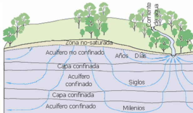
ILUSTRACIÓN 2.1 Diagrama del agua subterránea y agua superficial con términos de vocabulario. En esta ilustración, las flechas en azul muestran el flujo del agua subterránea bajo la superficie. (Diagrama: USGS)
