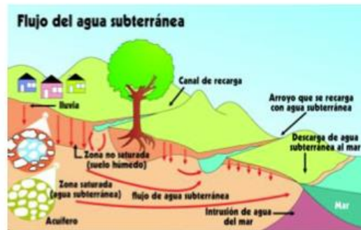
ILUSTRACIÓN 2.2 Diagrama del flujo del agua subterránea con zonas de recarga y descarga.
