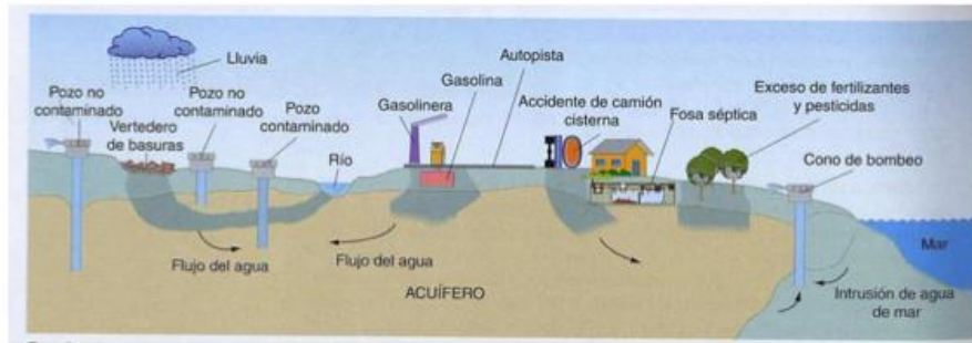
ILUSTRACIÓN 2.5 Diagrama que muestra las posibles actividades contaminantes de un acuífero.
