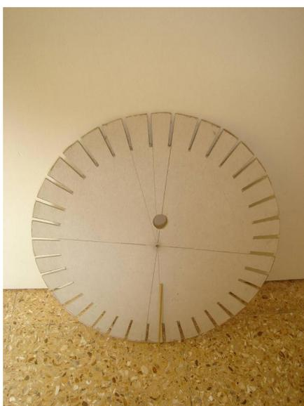
**Figura 1.-** Imagen de un estroboscopio a ranuras.
