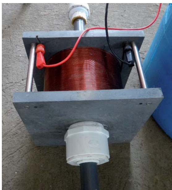
Figura 1. Solenoide adaptado al circuito de recirculación.
