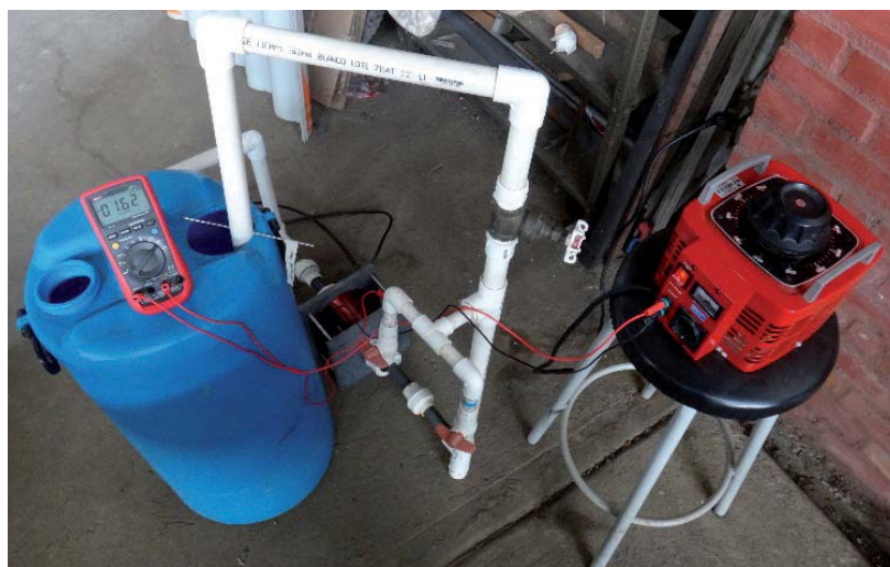
Figura 3. Circuito de recirculación de bio-fertilizante.
