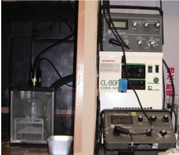
Gambar 2. Peralatan yang digunakan untuk mengukur evolusi oksigen terlarut, antara lain: DO meter, pengatur suhu air, akuarium, botol BOD yang berisi air laut steril, probe DO meter
