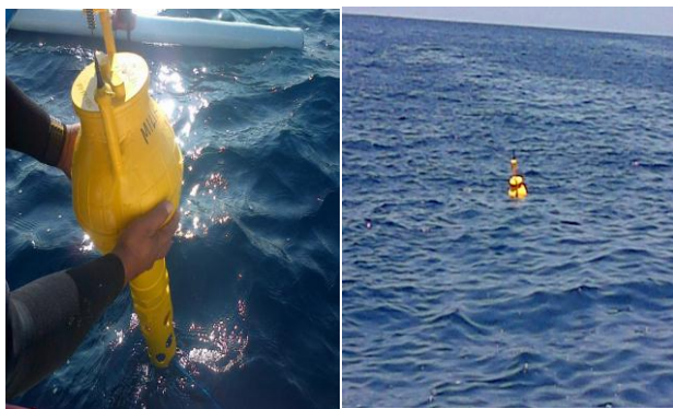
Gambar 3. Coastal drifter yang dipergunakan pada saat survei
