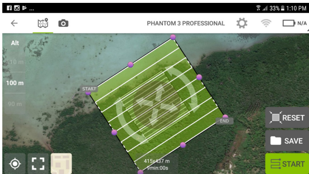
Gambar 1. Tampilan pada aplikasi Pix4D Capture yang menunjukkan jumlah dan jalur terbang, ketinggian terbang, area yang tercover dan perkiraan durasi pemotretan foto udara.
