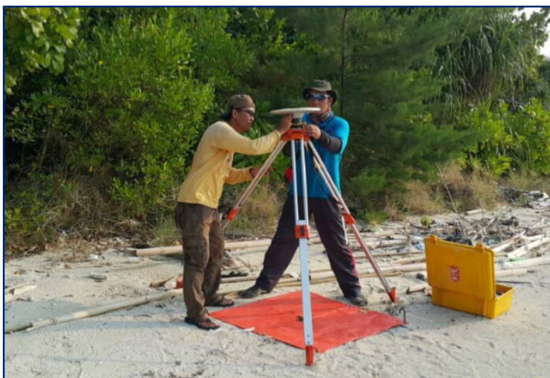
Gambar 2. Pengambilan koordinat (GCP) menggunakan GPS Geodetik di atas benchmark . Figure 2. GCP Coordinate retrieval using Geodetic GPS on benchmarks.
