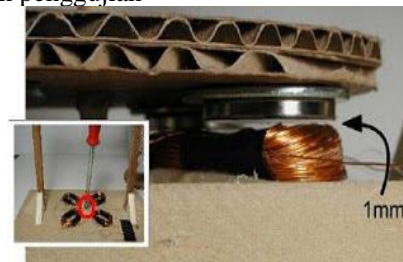
Gambar. Jarak magnet dengan lilitan
