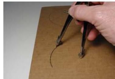
Gambar. Pembuatan sudu kincir angin
