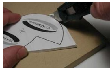
Gambar. Pemotongan sudu kincir angin
