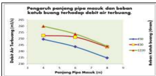
Gambar 4 Grafik pengaruh panjang pipa masuk dan beban katub buang terhadap debit air terbuang
