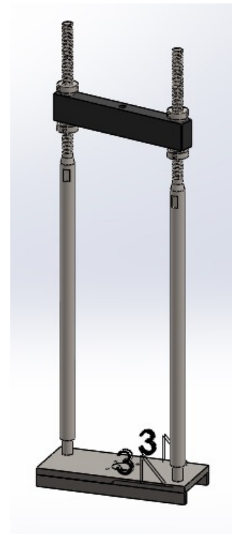
Gambar 2. Desain 3D Rangka load-frame GLT04
